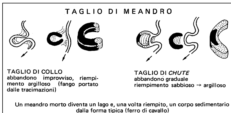
Fig. 2: Taglio di meandro e riempimento del canale morto (da RICCI LUCCHI, 1980).
